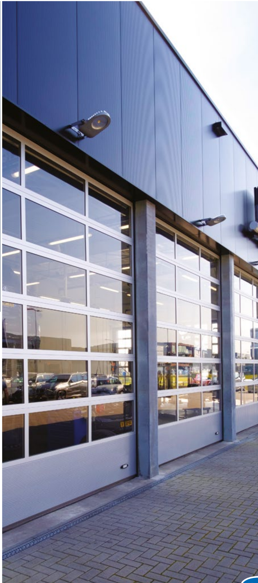
U-waarde Novolux 60 mm sectionaaldeur 5000 x 5000 mm: 2,33 W/m 2 K, bij drievoudige beglazing
