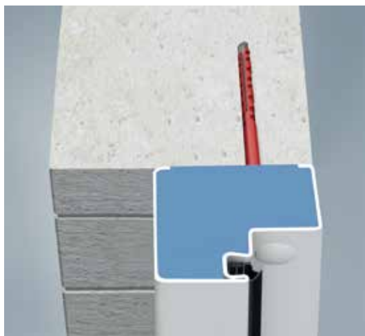
Blokkozijn type 1 montage in de sponning
