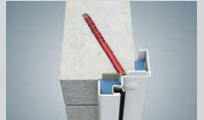
Verdekte montage in steen/beton
