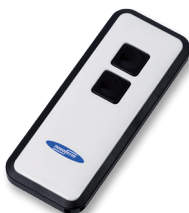
Handzender Mini-Novotron 522 Tweekanaals, 433 MHz, KeeLoq-Wisselcode
