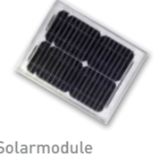
Solarmodule voor Novomatic 423 Accu uitvoering Vermogen Pmax: 10Wp Nominale spanning: 21.5V Stroom bij Pmax: a 0,5A Afmetingen: 370 x 310 mm 4,1 kg
